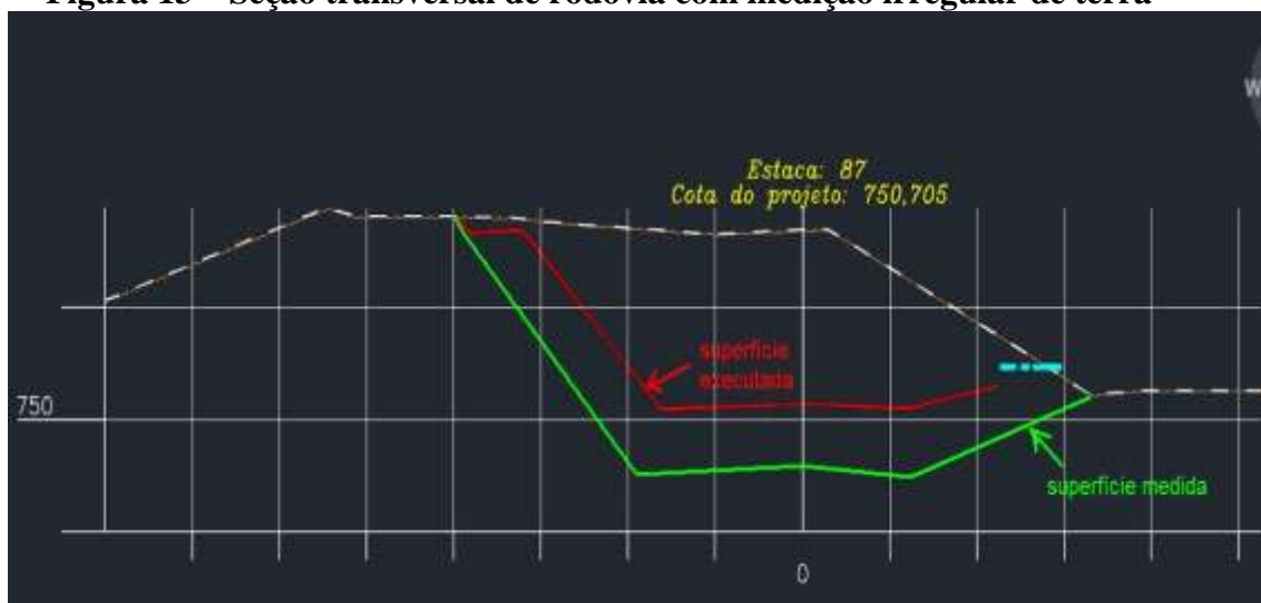
Figura 13 – Seção transversal de rodovia com medição irregular de terra
